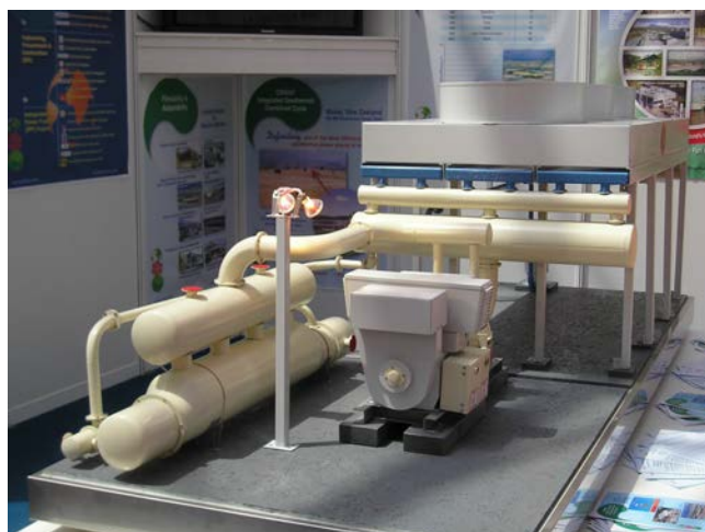
Maquette d'une centrale géothermique ORC à fluide binaire (ORMAT)
